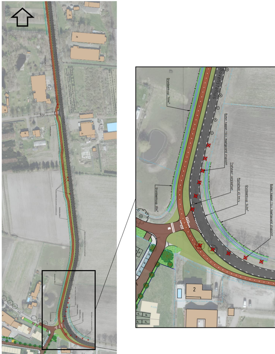
Afbeelding 7 Schetsontwerp Bovenstehuis, met uitsnede afbuigende voorrangsweg Zijp-Bovenstehuis
