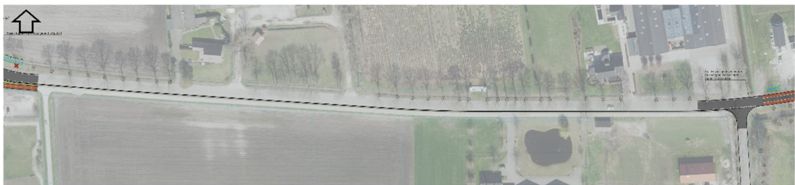
Afbeelding 6 Schetsontwerp Zijp, aanbrengen bermverbreding (betonsloof of grasbetonstrook)
