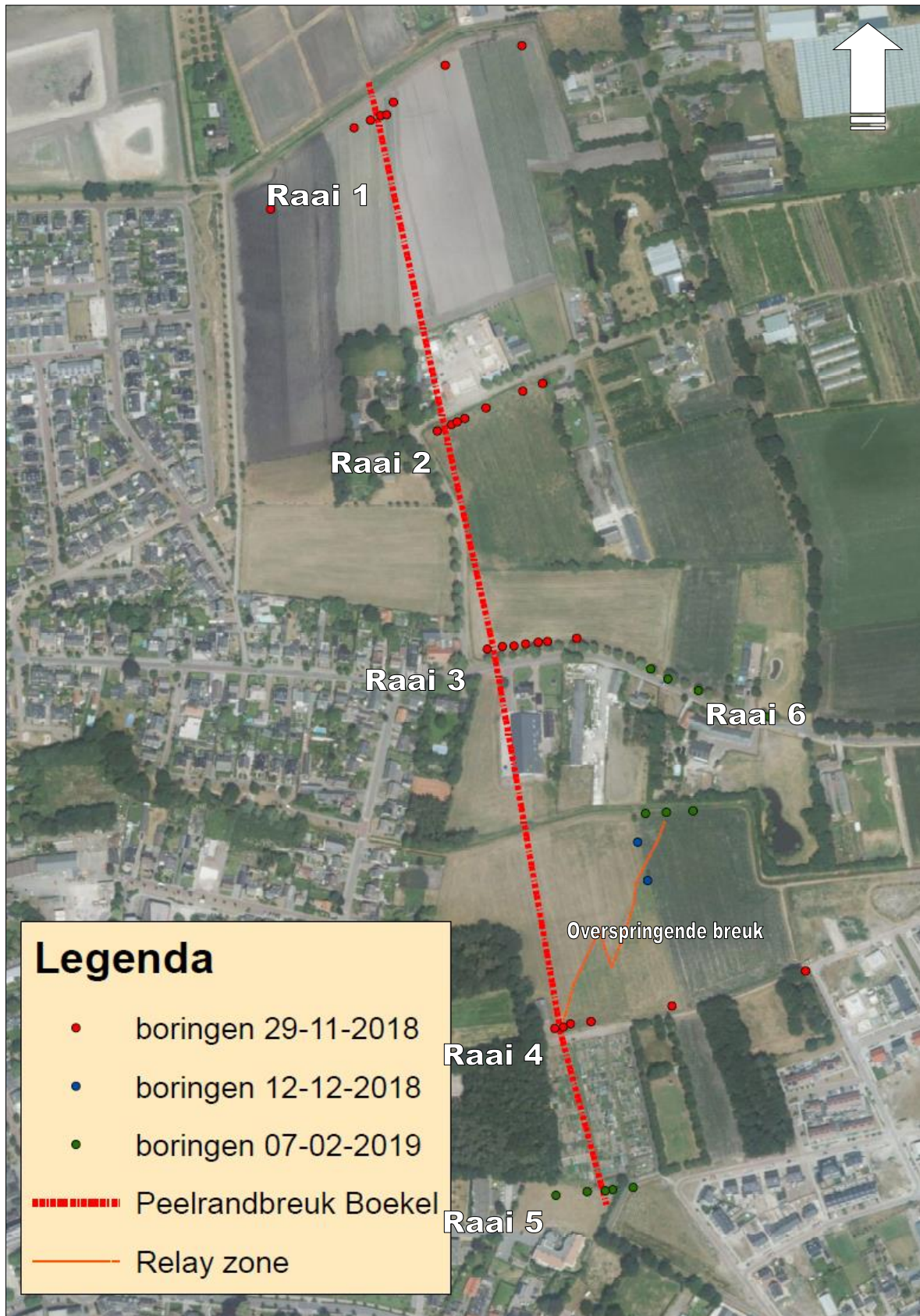
Figuur 9: Ligging van de Peelrandbreuk(zone) en overspringende breuk (relay zone) op basis van alle boringen, grondwatersprongen en aanvullende omgevingsscan.
